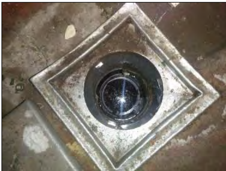
Figure 8 : Vue du réservoir d'huile d'un ancien pont élévateur avant son pompage
